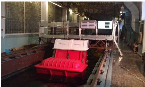
Рис. 8. Макет волновой электростанции в масштабе 1:2,5
