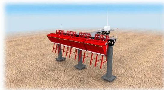
Рис. 4. Установка волновых демпферов энергетического блока ПЭВ на вертикальных опорах
