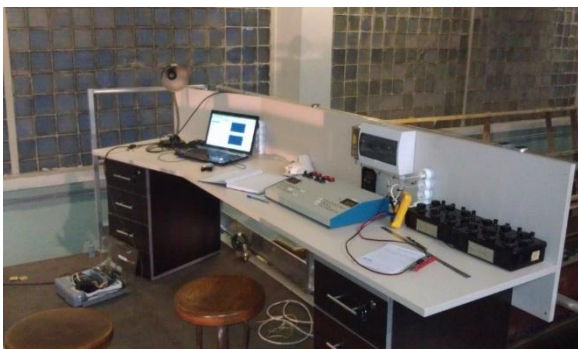
Рис. 9. Пульт управления макета волновой электростанции
